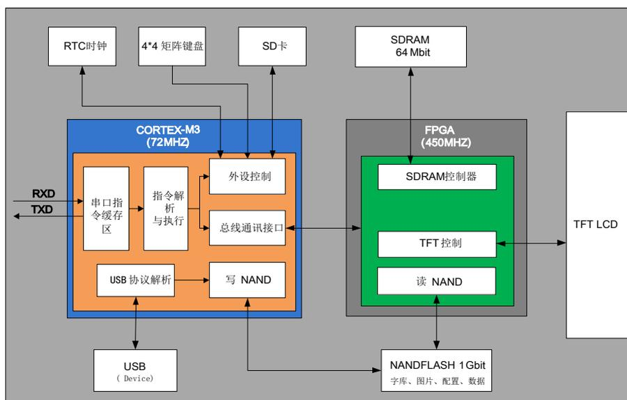
图 8-1 经济型串口屏内部结构图
