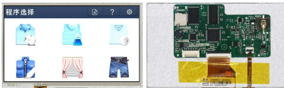
图 1-1 7.0 寸电阻触摸参考图
